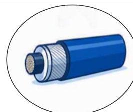
高圧送電ケーブル
