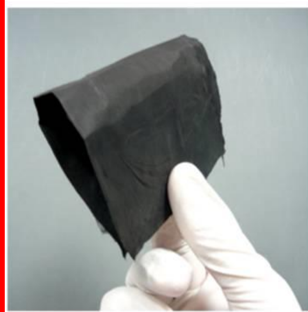
卵殻膜から生まれた 新たな電極材料(シート状)
