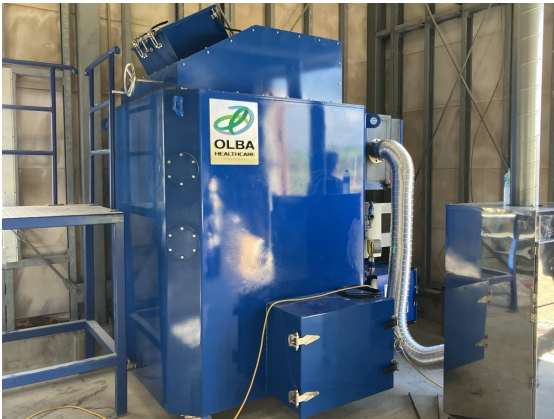
↑低熱分解型アップサイクルユニット「OLSTECH®」
