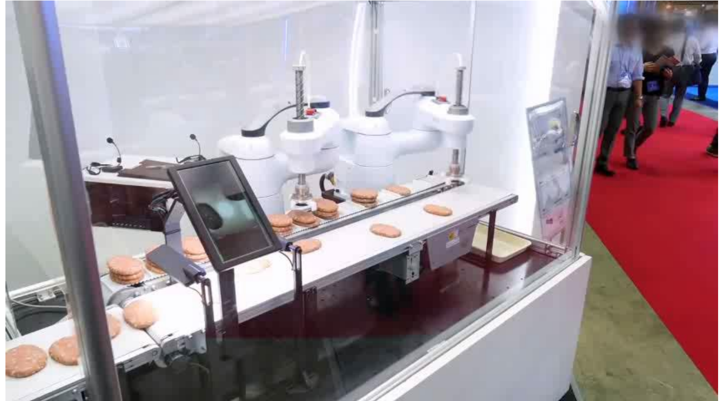
ロボットによる冷凍ハンバーグの仕分け・スタッキング自動化（デモ映像）
