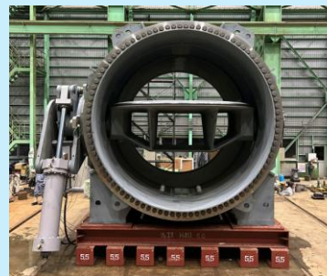
水力発電設備 大型バルブ
