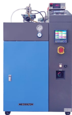
水電解評価装置
