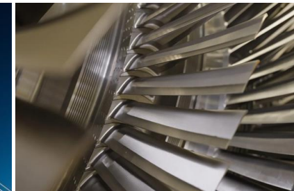
発電プラント (タービンブレード)
