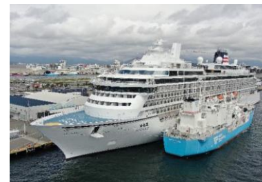
飛鳥Ⅲへのバンカリングの様子
