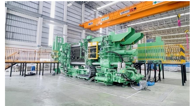
タイ工場導入中の1,650トン級ダイカストマシン
