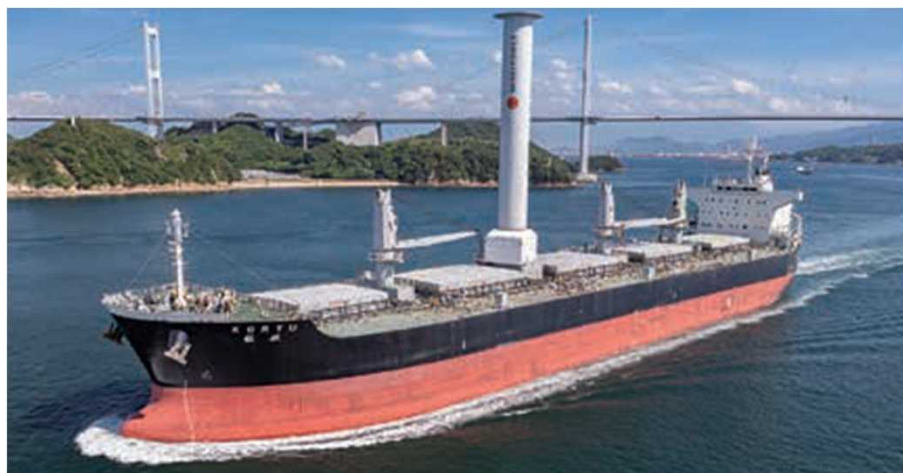
ローターセイルを装置し、船舶の省エネ運航を実現
