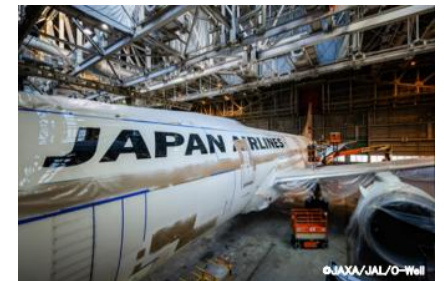
リブレット施工作業風景
