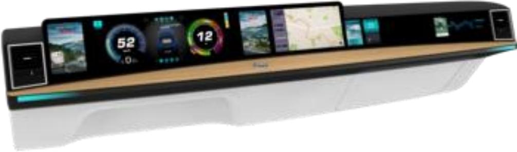
ディスプレイの電子化や画面の大型化・高精細化により、高い反射防止機能と防汚性能を持つ当社の反射防止フィルムの採用が進んでいます。その他にも、光学弾性樹脂（SVR）や異方性導電膜（ACF）等も自動車ディスプレイ向けに伸長しています
