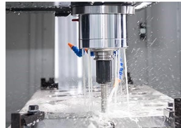
ドリルで加工物を削る際に熱が発生するため冷却が必要
