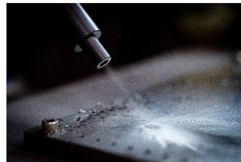
水と圧縮エアのみでミクロンサイズの異物除去が可能なノズル。半導体の精密洗浄工程で貢献。ウエハを研磨したあとに残る薬剤などを洗浄。
