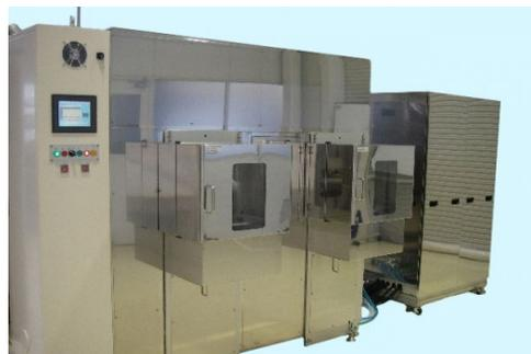
はんだ付けに用いる補助剤「フラックス」のカスを洗浄する装置。フラックスが残ったままだと、最終製品化の際に不具合が生じる。
