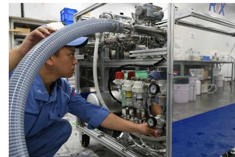
半導体製造装置の周辺機器（電源装置、ヒーター、真空ポンプなど）の修理再生サービスを展開。国内大手メーカー向けに実績多数。
