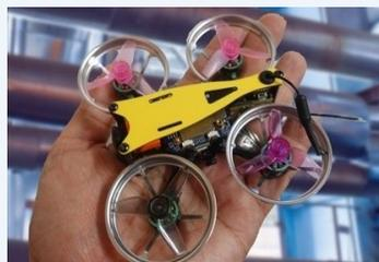
独自開発の作業型ドローンなどを利用したプラント向けの点検ソリューションを開発・提供。人間が進入できない狭い箇所などを短時間で高品質に点検・撮影。
