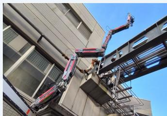
極限環境におけるロボット技術の開発や、AIを搭載した遠隔操作ロボットを製造・開発。高所点検用ヘビ型ロボットなど人間では過酷な現場作業を解放する。
