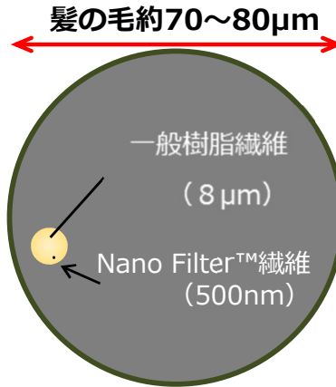
ナノファイバー：極細繊維 φ500nm (髪の毛の約1/140)
