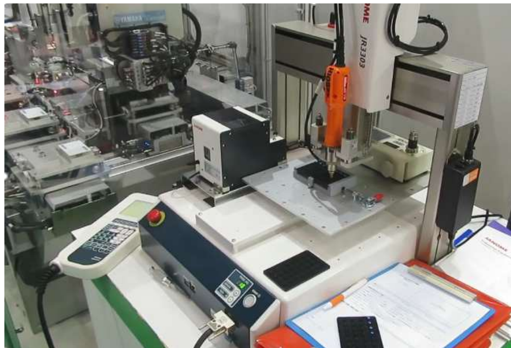
ロボットによるネジ締めの自動化（デモ映像）
