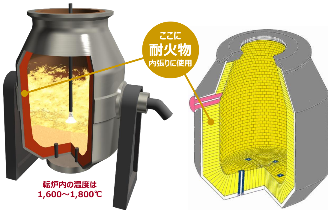
転炉での溶鋼の精錬
