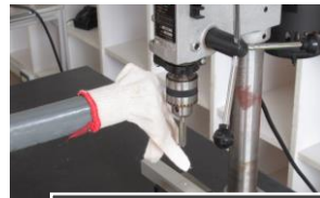
ボール盤巻き込まれ
