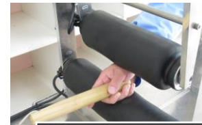
ローラー巻き込まれ
