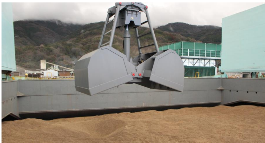
木質ペレットを船から荷揚げする様子
