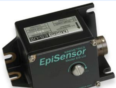
地震観測に使われる 加速度計 (Kinematics社開発)
