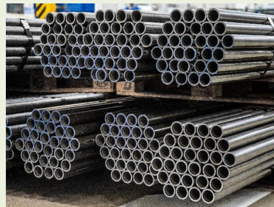
鋼管（ガス・水道用配管等）
