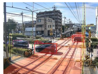
AI画像解析装置による踏切での物体検知の様子(イメージ)
