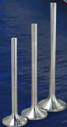
耐腐食性に優れた同一素材でありながら、表側は耐摩耗性、裏側は耐高温性という異なった特性を併せ持つ船用ディーゼルエンジン排気バルブ。この製品は、大同特殊鋼が誇る大型鍛造機と高速四面鍛造機の絶妙な連携により実現されました。その独自の技術と信頼性により国内シェアは100%、世界においても市場の約60%を占めています。
