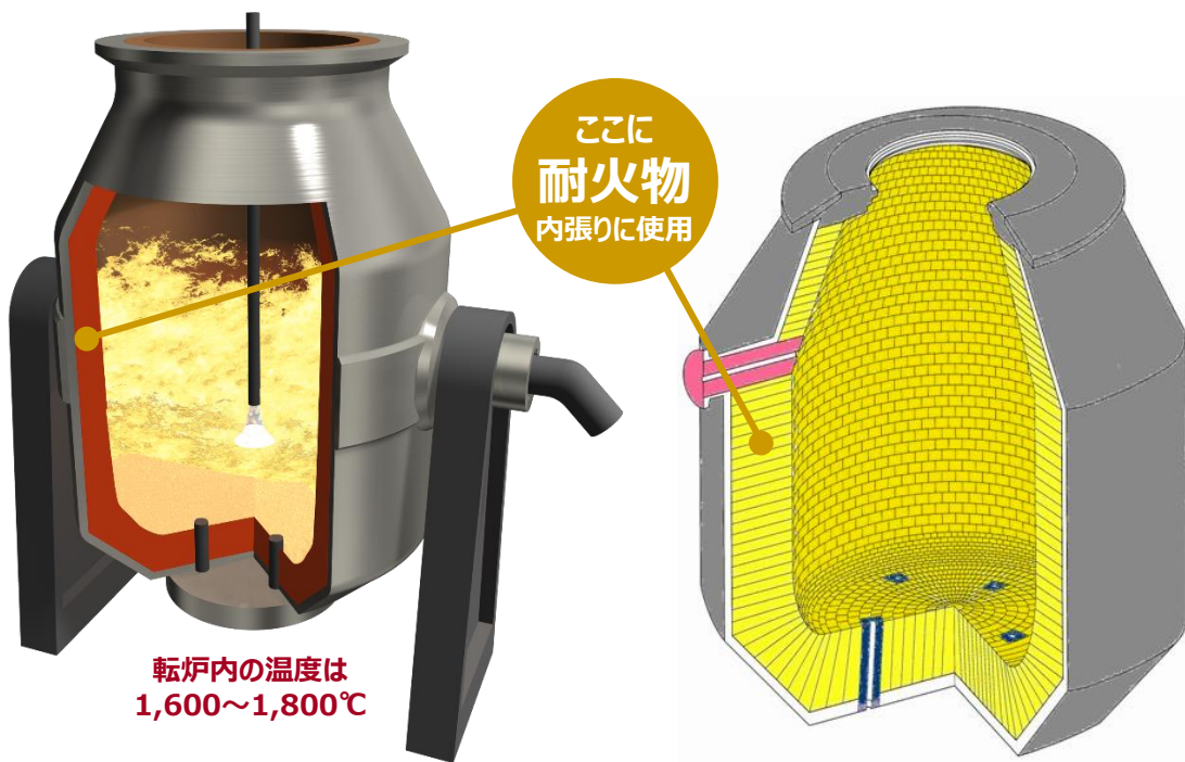
転炉での溶鋼の精錬
