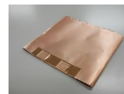
電池箔積層 (銅箔60枚)
