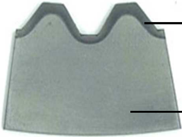
自動車用歯車部品 切断面図
