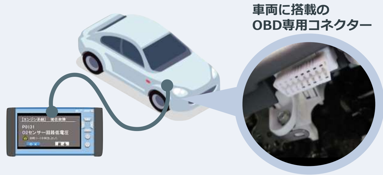
イメージ/OBD機器による車のスキャン
