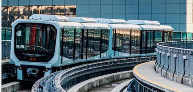
ゴムタイヤ式新交通システム (AGT 電力駆動による完全自動走行)
