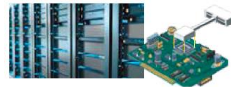
データセンター向けサーバーのCPU冷却用に開発した小型・高性能な相変化型冷却器(フラットサイフォレックス)
