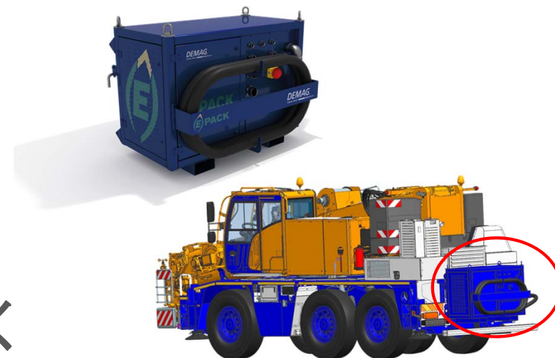
電動油圧ポンプユニットの「E-Pack」
