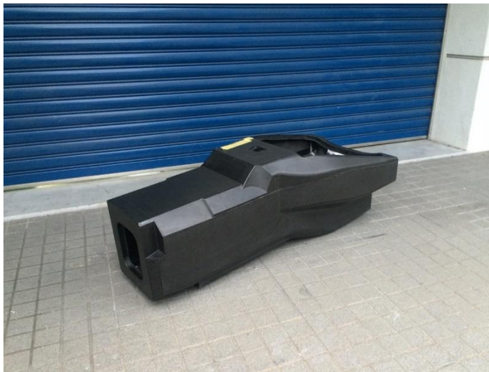
オートクレーブでCFRPを硬化、脱型
