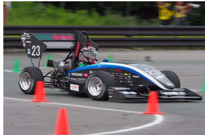
CFRPはモノコック(車体構造)に使用
