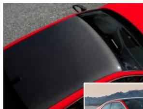
CFRPが採用された「Audi RS 5 Coupe」のルーフ
