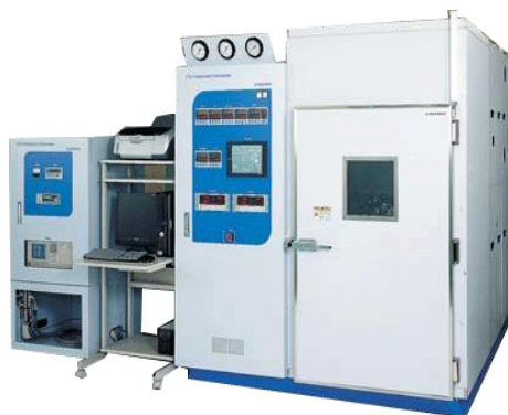
コンプレッサ 性能試験装置
