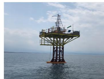
海底地盤調査のための鋼製籠
