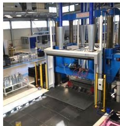
C.P.C.社（伊） 世界最大規模の複合材料プレス設備
