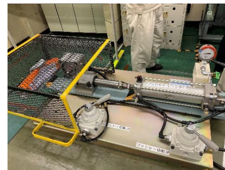
「残圧による挟まれ」を再現し、手を挟む危険性があることを学べる装置
