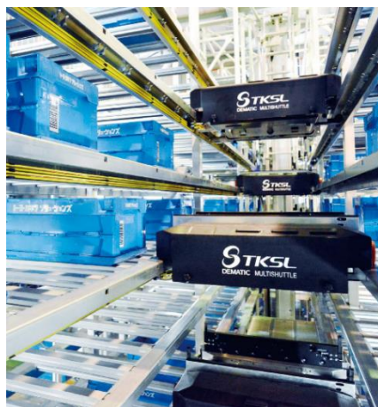
シャトルが棚の間を動き回り 各段の棚に荷物を出し入れを行う
