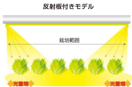
外側に照射された光を新設の『反射構造』により、光を内側に戻す事で、栽培範囲の光量が増える。
