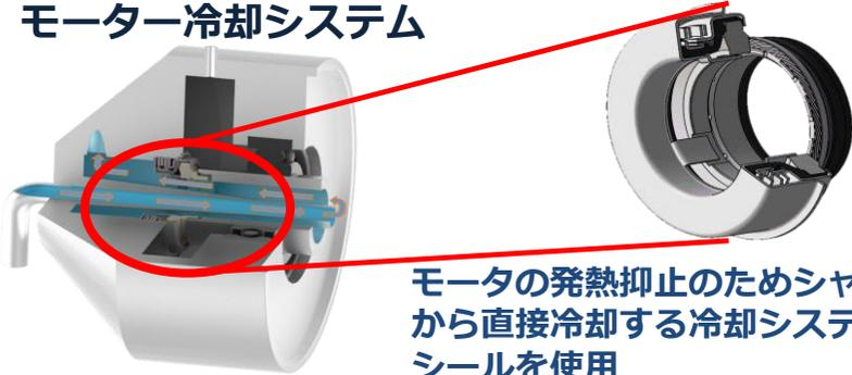
モータの発熱抑止のためシャフト側から直接冷却する冷却システムにシールを使用
