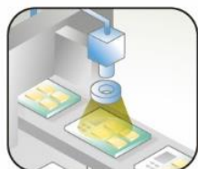
製造時における 画像認識システム
