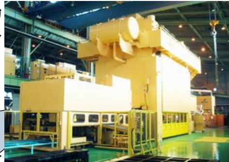
栃木工場 3000トントランスファープレス
