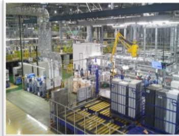
家電リサイクル 冷蔵庫処理ライン
