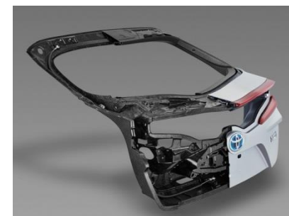
新型「プリウス PHV」のバックド アの骨格部材に供 給。量産車初採用 (2017年3月)
