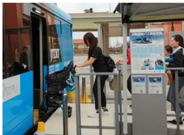
ベビーカーでの乗車の様子 (±40~20mmでの幅寄せ、停止)
