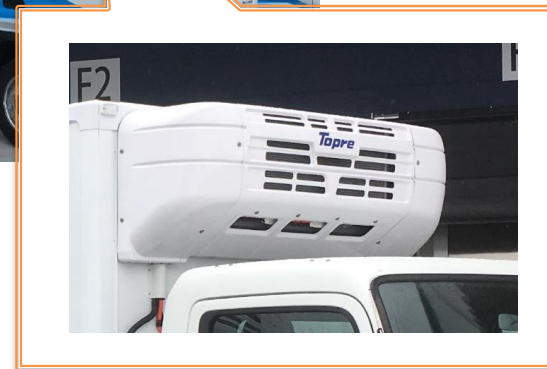
東プレ製電気式冷蔵機を搭載
