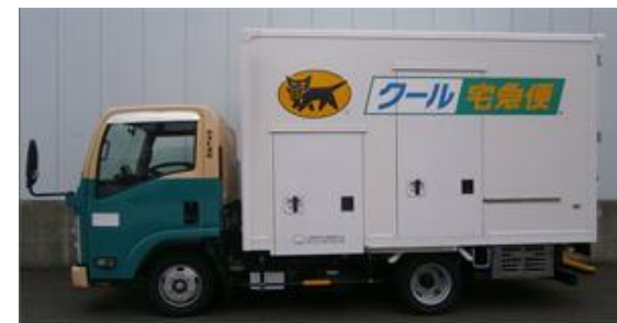
コンテナ内に蓄冷材を搭載することで 車両前方の冷凍コンプレッサーが不要に。
