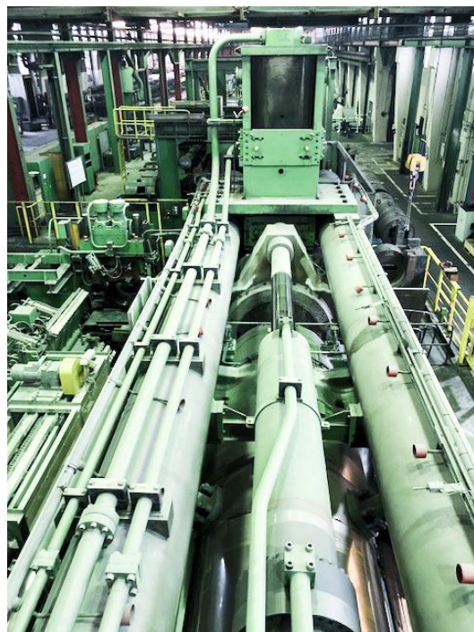
STEP-G Bonn工場 100メガニュートン押出機
