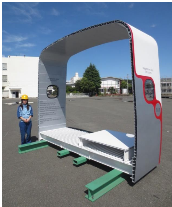
試作したモックアップ (1mの部分構体、重さ239kg)
