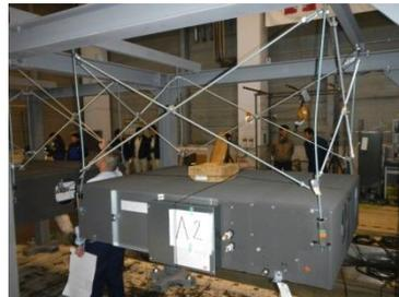
重量機器振止め支持耐震検証
