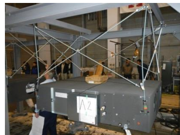
重量機器振止め支持耐震検証
