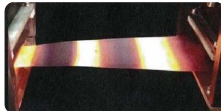
DHによる板材(異形状)縞状加熱
