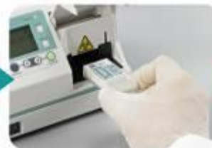
試薬カートリッジを装置にセット
